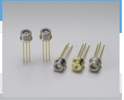
S5971, S5972, S5973シリーズは、可視～近赤外用の高速Si PINフォトダイオードです。低バイアスにて優れた広帯域特性を実現しており、光通信の他、高速測光などに最適です。また、S5973シリーズには光ファイバとの結合効率が高いミニレンズ付のS5973-01、紫色レーザー検出に最適な紫色高感度のS5973-02があります。
